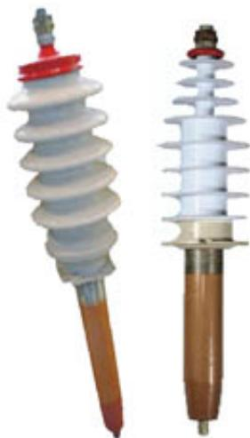
Ввод конденсаторный состоит из конденсаторной втулки и крышки, выполненной из фарфора либо кремнийорганической резины. Конденсаторная втулка представляет собой токоведущий стержень и намотанный на него слоями изоляционный материал. Полость между крышкой и втулкой заполнена электроизоляционным материалом. На верхний конец ввода для крепления внешней ошиновки установлены:
